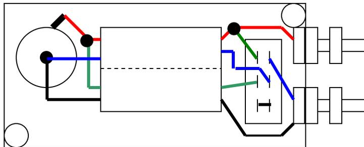
4:1/1:1 Balun Wiring Diagram
